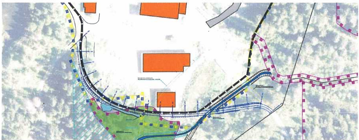
Abb. 6: Die neue Trasse des verlegten Wirtschafts- und Wanderwegs bildet die südliche Grenze des Bebauungsplangebiets. Zum neuen Verlauf des Ramsenbächles wird ein Abstand von 5,00 Meter (Böschungsoberkante) eingehalten.
