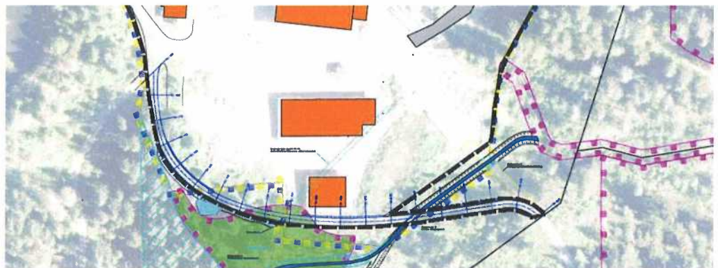
Abbildung 12: Die neue Trasse des verlegten Wirtschafts- und Wanderwegs bildet die südliche Grenze des Bebauungsplangebietes. Zum neuen Verlauf des Ramsenbächles wird ein Abstand von 5,00 Meter (Böschungsoberkante) eingehalten.
